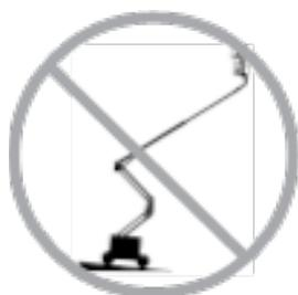
No suba ni extienda la pluma si la máquina no se encuentra sobre una superficie firme y nivelada.
