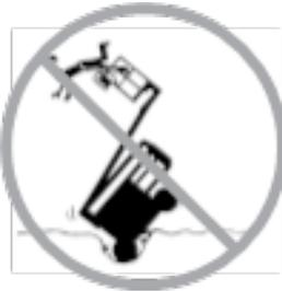
Cuando conduzca la máquina en posición replegada por terrenos irregulares, escombros, superficies inestables o resbaladizas, o cerca de socavones y pendientes, exteme las medidas de precaución y conduzca a velocidad reducida.
