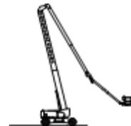
Para eliminar el fallo, mantenga presionado el conmutador de la alimentación auxiliar y active la función de elevación del brazo secundario hasta que éste empiece a extenderse.
