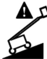
Si al subir la plataforma suena la alarma de inclinación, el piloto de máquina no nivelada se encenderá y la función de desplazamiento dejará de funcionar en una o en ambas direcciones. Identifique el estado de la pluma sobre la pendiente tal y como se indica a continuación. Antes de desplazar la máquina a una superficie firme y nivelada, lleve a cabo los siguientes pasos para bajar la pluma. No gire la pluma mientras esté bajando.
