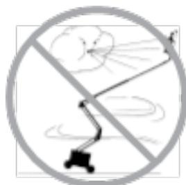
No eleve la pluma si la velocidad del viento es superior a 28 mph/12,5 m/s. Si la velocidad del viento es superior a 28 mph/12,5 m/s cuando la pluma está elevada, baje la pluma y no siga utilizando la máquina.
