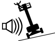
Siga el procedimiento de bajada de la pluma (descrito en las instrucciones de funcionamiento) para restablecer la función de desplazamiento.
