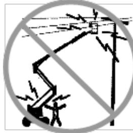
Si la máquina entra en contacto con líneas eléctricas activas, aléjese de ella. Ninguna persona, ya se encuentre en el suelo o en la plataforma, debe tocar ni manejar la máquina hasta que las líneas eléctricas activas hayan sido desconectadas.
