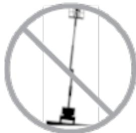
No confíe en la alarma de inclinación como indicador de nivelación. La alarma de inclinación suena en la plataforma sólo cuando la máquina se encuentra en una pendiente muy pronunciada.
